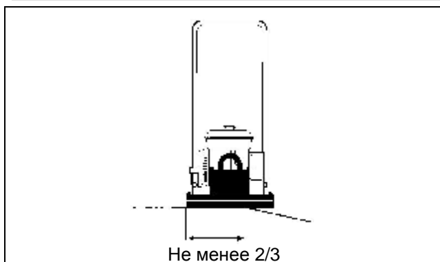
Положение виброплиты при работе на участках перегиба
